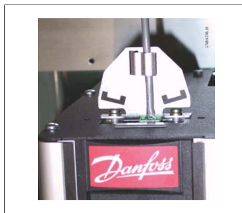
Рисунок 3.69: Подключение шины fieldbus сверху.
