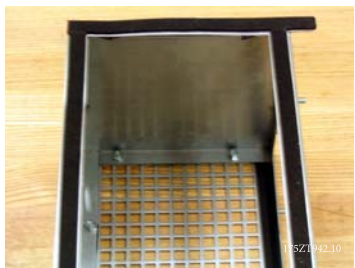
Рисунок 3.43: Прокладка прилегает к обеим сторонам кронштейна преобразователя частоты и вентиляционной верхней крышки воздуховода.
