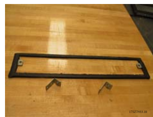
Рисунок 3.32: Переходник нижнего воздуховода с установленной прокладкой
