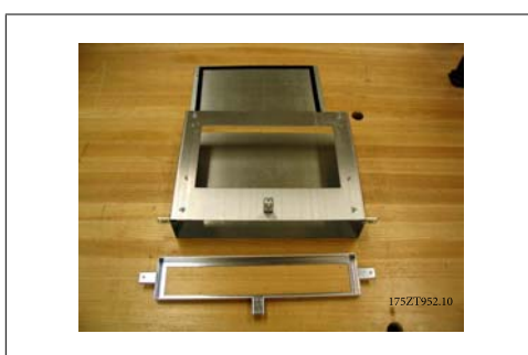
Рисунок 3.52: Частично собранный нижний воздуховод
