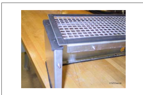
Рисунок 3.41: Прокладка охватывает край, образуя уплотнение между воздуховодом и вентиляционной верхней крышкой.
